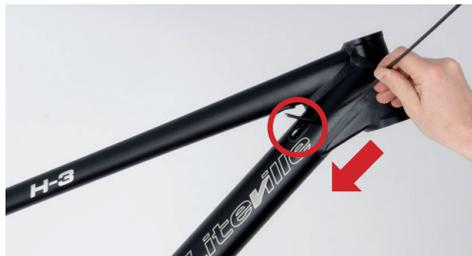
Abb: Einfädeln am Unterrohr.
