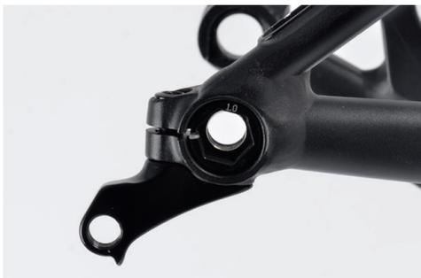
Abb. zeigt: Insert mit Klemmschlitz korrekt ausgerichtet
