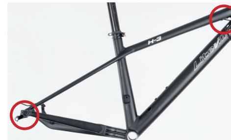
Abb.: Außenhülle Schaltwerk / Ein- und Ausgang.
