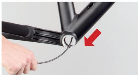
Abb: Herausziehen aus dem Tretlager
