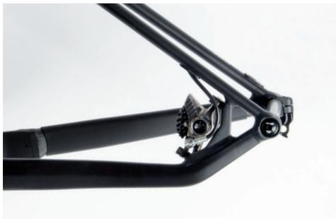
Abb.: Bremsattel auf PM mit Leitungsabgang Shimano.
