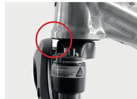
Abb. Freiraum zum Steuerrohr
