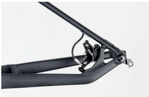
Abb.: Bremsattel auf PM mit Leitungsabgang SRAM.
