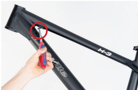
Abb.: Ausgang Bremsleitung Oberrohr.
