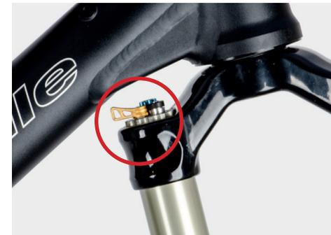
Abb. Freiraum zum Unterrohr
