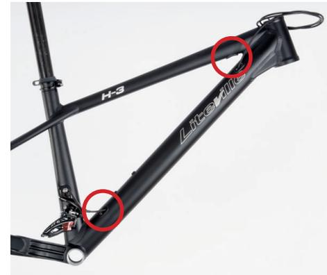
Abb: Fertig montierte Außenhülle Umwerfer
