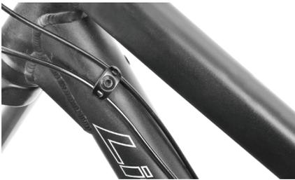
Die Außenhülle für das Schaltwerk und die Bremsleitung wird mit Halteklammern auf der Oberseite des Unterrohrs montiert. Am Steuerkopfbereich können Sie alternativ zu der bekannten Standardverlegung des Schaltzuges und der Bremsleitung, wie hier abgebildet, beide links um das Steuerrohr herum führen um mehr Freigang beim Einlenken zu erhalten und Scheuerstellen am Rahmen zu reduzieren.
