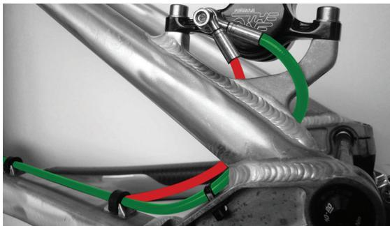
Verwenden Sie für die Fixierung der Bremsleitung auf der linken Kettenstrebe die mitgelieferten Nylon Halteclips. Sollten Sie dennoch Kabelbinder verwenden, ziehen Sie diese bitte nur leicht an, damit die Bremsleitung beim Einfedern noch gleiten kann werden die Kabelbinder zu stark angezogen, kann es quitschen.
