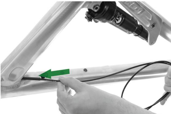
Sprühen Sie ein wenig Silikonspray in das Schutzröhrchen. Fädeln Sie die Zughülle, von der Unterrohr-Seite her, in das Schutzröhrchen ein, bis sie an der Durchführung zur rechten Kettenstrebe ansteht.
