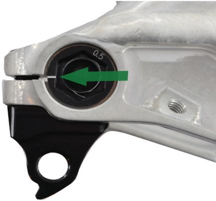
Die Klemmschraube (Inbus/Größe 5) im rechten Ausfallende dient ausschließlich zur Befestigung des Schaltauges und zur Klemmung des Achs-Inserts. Sie muss zum Ausbau der X-12 Steckachse, bzw. des Hinterrades, nicht geöffnet werden!
