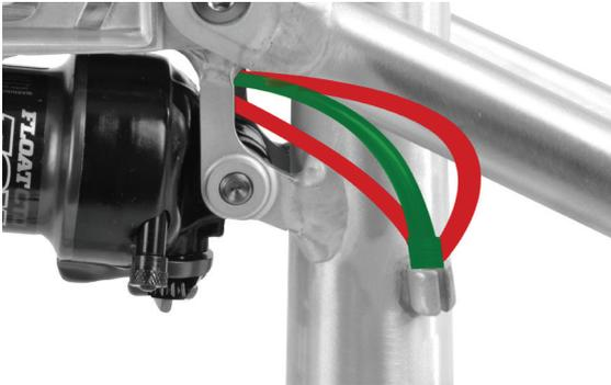
Der Schaltzug verläuft zwischen Oberrohr und Dämpfer. Lassen Sie den Schaltzug zwischen der linken hinteren Dämpferaufnahme und dem Sitzrohr austreten. Die Schaltzughülle für den Umwerfer sollte, um eine einwandfreie, unproblematische und dauerhafte Funktion zu gewährleisten, nicht zu „direkt“ und auch nicht mit einem zu großen „Bogen“ verlegt werden.
