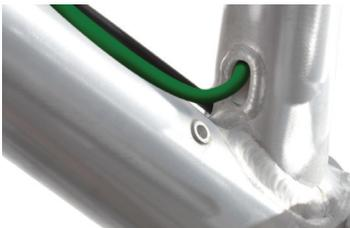
Der 301 Mk11 ist für die Montage der RockShox Reverb Stealth Vario-Stütze u.ä. Modelle vorbereitet.
