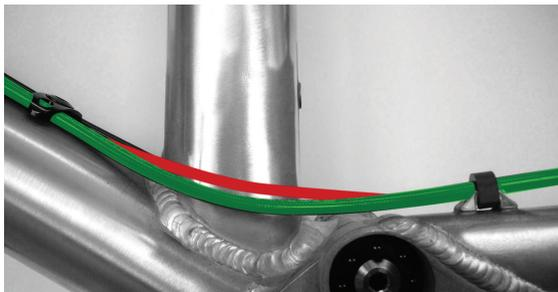
Bitte beachten Sie, dass sich die Bremsleitung beim Einfedern des Hinterbaus verkürzt und verlegen Sie die Leitung wie im Bild gezeigt ausreichend lang!
