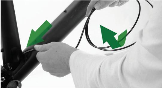
Sprühen Sie ein wenig Silikonspray in das Schutzröhrchen. Fädeln Sie die Zughülle, von der Unterrohr-Seite her, in das Schutzröhrchen ein, bis sie an der Durchführung zur rechten Kettenstrebe ansteht.
