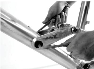
Passen Sie die Länge der Bremsleitung nicht an, wird der Dämpfer, nach Demontage an der vorderen und hinteren Aufnahme, entnommen. Entfernen Sie anschließend die schwarzen M15 Aluminium-Schrauben (Inbusschlüssel/Größe 8), welche den Umlenkhebel mit dem Unterrohr verbinden. Bitte beachten Sie, dass alle Schrauben werkseitig mit Schraubensicherung versehen sind. Erwärmen Sie daher gezielt die Schrauben vor dem Lösen, z. B. mit einem LötKolben (siehe FAQ).
