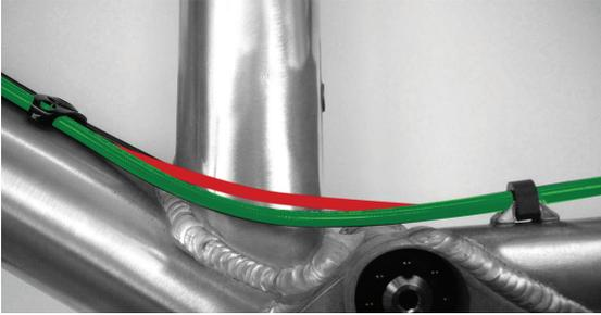
Bitte beachten Sie, dass sich die Bremsleitung beim Einfedern des Hinterbaus verkürzt und verlegen Sie die Leitung ausreichend lang!
