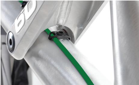
Die Außenhülle für das Schaltwerk und die Bremsleitung werden mit Halteklammern auf den Zughalter-Pads am Unterrohr montiert. Sie erreichen damit eine optimale Zugverlegung.
