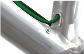
Der 601 Rahmen ist für die Montage der RockShox Reverb Stealth Vario-Stütze vorbereitet. Der Zugeingang in den Rahmen befindet sich an der linken unteren Seite des Sitzrohrs. Verlegen Sie die Leitung der RockShox Reverb Stealth Vario-Stütze wie in der Montage- und Bedienungsanleitung des Herstellers beschrieben.
