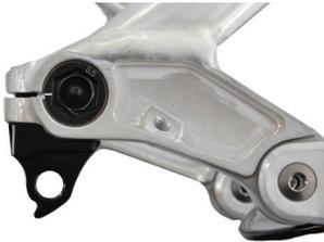
**Achtung:** Aufgrund von geänderten Schaltwerken/Schaltaugen passen am 601 Mk3 (ab Januar 2014) die RockGuard-Typen I und II nicht mehr. Verwenden Sie zukünftig RockGuard Typ III. Statt Ärger mit verstellten Schaltungen und schiefen „Soft-Schaltaugen“... stabile, zuverlässige Funktion 365 Tage im Jahr.
