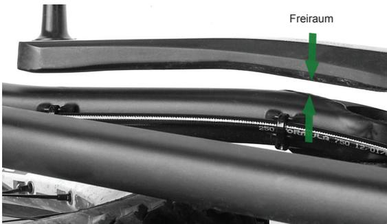
Es können evtl. nicht alle am Markt erhältlichen Kurbel- und Tretlager-Einheiten verwendet werden. Das Tretlager hat BSA Gewinde und eine Gehäusebreite von 73mm. Achten Sie beidseitig auf Freiraum zwischen Kurbelarmen und Kettenstreben bzw. rechtem Kurbelarm und Syntace SCS Kettenführung. Bei Montage von Shimano-Umwerfern ist darauf zu achten, dass ausschließlich E-Type-Modelle und E-Type-taugliche Innenlager verwendet werden.
