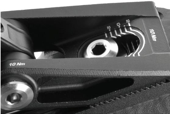
Die Schraube an der vorderen Dämpferaufnahme „ganz unten“ bedeutet: „flachste Winklereinstellung“ Sitz- und Steuerrohr und „tiefste Tretlager-Einstellung“.
