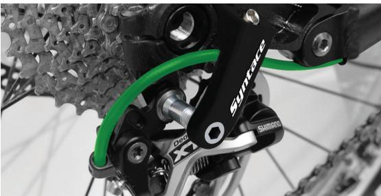
Der Austritt für den Schaltzug des Schaltwerkes befindet sich am unteren Ende der rechten Kettenstrebe.
