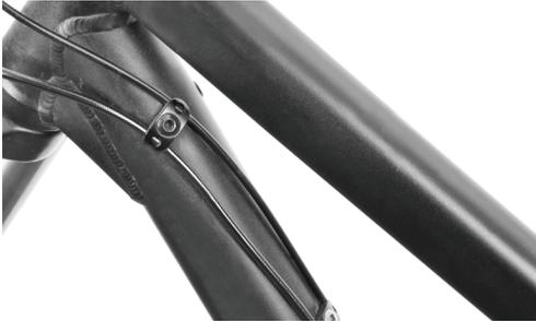
Wir empfehlen die Verlegung des Schaltzuges/ der Bremsleitung, wie hier abgebildet, links um das Steuerrohr herum. Somit wird der Freigang beim Einlenken gewährleistet und Scheuerstellen am Rahmen werden vermieden.
