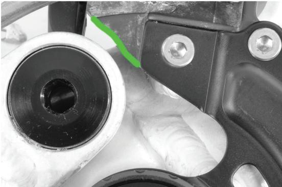
Geben Sie auf beide Seiten des Umwerfer-Leitbleches (wo der Umwerfer zwischen Tretlager und rechter Lagerschale geklemmt wird) etwas Fett. Fixieren Sie den Shimano E-Type-Umwerfer mit der (Lieferumfang des Umwerfers) beiliegenden Schraube.
