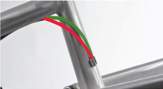
Die Schaltzughülle für den Umwerfer sollte, um eine einwandfreie, unproblematische und dauerhafte Funktion zu gewährleisten, nicht zu „direkt“ und auch nicht mit einem zu großen „Bogen“ verlegt werden.
