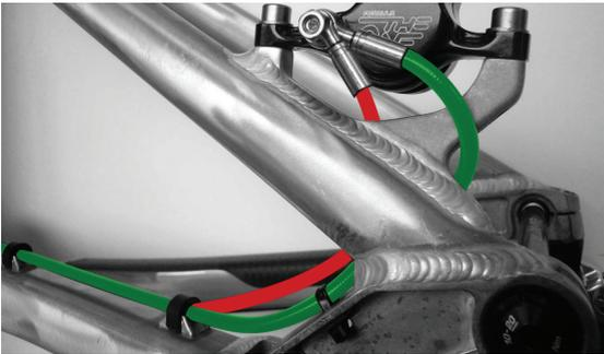
Verwenden Sie für die Fixierung der Bremsleitung auf der linken Kettenstrebe die mitgelieferten Halteclips. Sollten Sie dennoch Kabelbinder verwenden, ziehen Sie diese bitte nur leicht an, damit die Bremsleitung beim Einfedern noch „gleiten“ kann. Werden die Kabelbinder zu stark angezogen, können unangenehme Geräusche auftreten.
