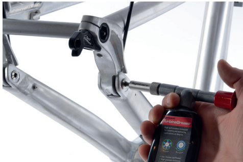
Abb. zeigt: Abschmierbare Lagerstelle am Horst-Link
