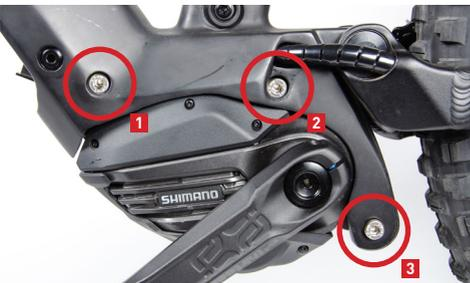
Abb.: Die zu lösenden drei Motorschrauben
