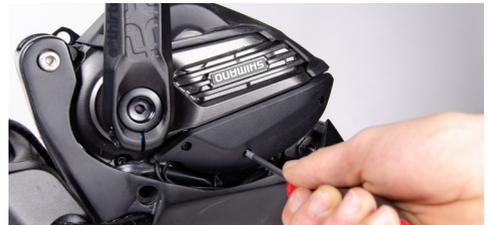
Abb.: Entfernen der Motorschutzabdeckung
