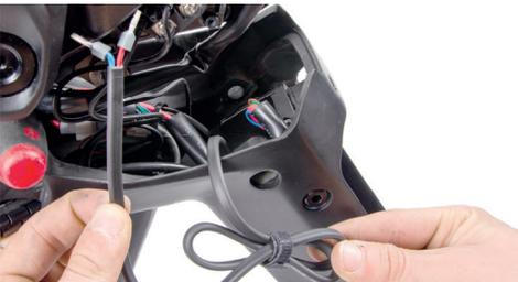
Abb.: Eingeschlaufenes Stromversorgungskabel
