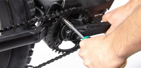
Abb.: Lösen des Kettenblatts
