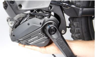
Abb.: Ausklappen des Motors.
