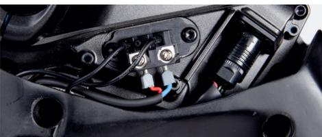
Abb.: Angeklemmtes Stromversorgungskabel am EP8
