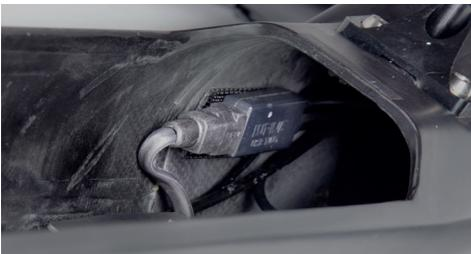
Abb.: Angeschlossene USB-TWO Weiche
