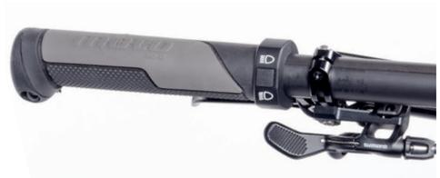
Abb.: Kabelgebundener Taster am Lenker
