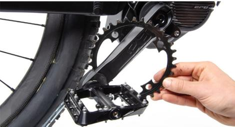
Abb.: Abziehen des Kettenblatts
