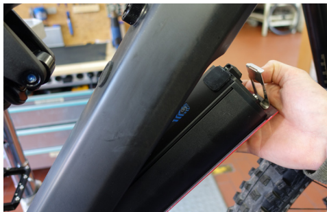
Abb.: Einbau des Akkus
