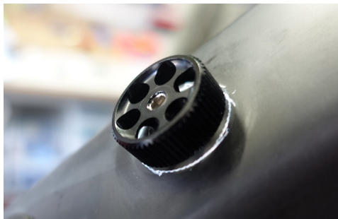
Abb.: Genau am Riß platzierte Akku-Halteschraube
