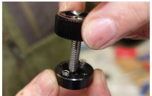
Abb.: Montieren des POM Inserts
