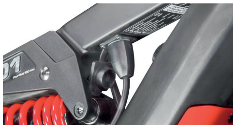
Abb.: Ladebuchse beim 301CE Mk1 Pro, AIR.LIMITED, AIR, PRO.ONE und PRO.TWO
