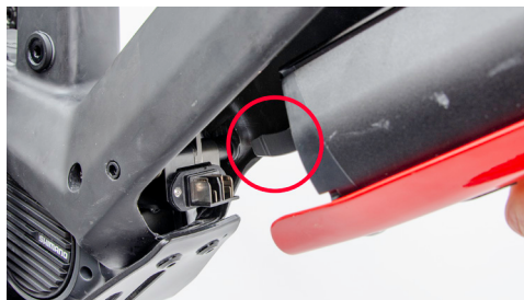
Abb.: Einfügen mittels Führungszapfen
