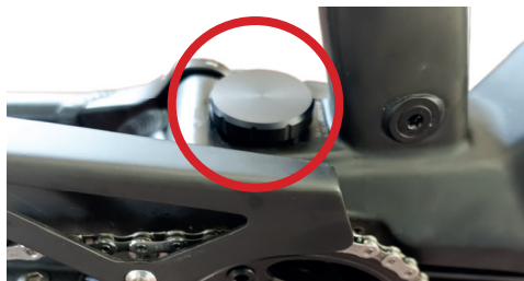
Abb.: Ladebuchse 301CE Mk1 mit „Volcano Port“ Upgrade
