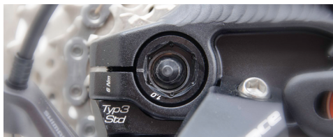
Abb.: Korrekt ausgerichtetes Insert mit Klemmschlitz
