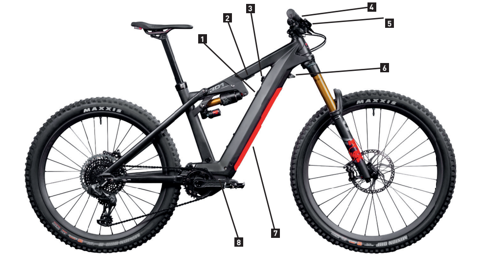
Abb.: Liteville 301CE Mk1 AIR.LIMITED mit Shimano EP8 und Ladeport am Oberrohr
