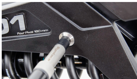
Abb.: Abschmierbare Lagerstelle am Oberrohr
