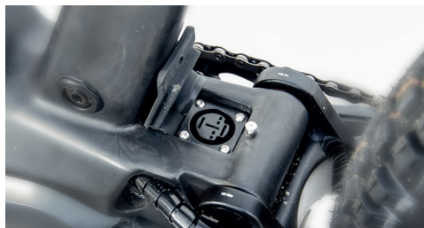
Abb.: Ladebuchse beim 301CE Mk1 ( ohne Upgrade )
