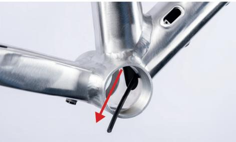
2. Foam Tube ins Unterrohr aufschieben.
