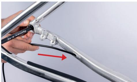
3. Führe die Bremsleitung von hinten an der linken Kettenstrebe ein.
