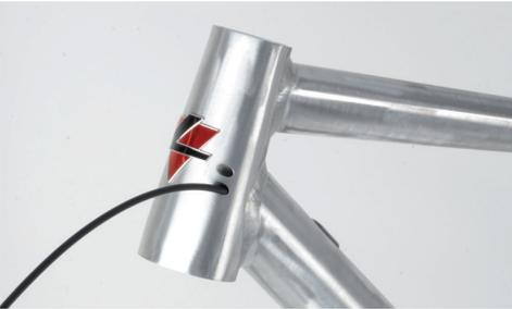
1. Schaltaußenhülle vom Steurrrohr aus in das Unterrohr einführen und beim Tretlager herausführen.
