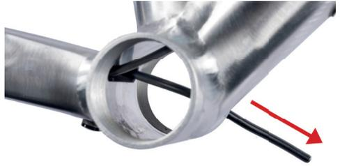
4. Bremsleitung weit genug aus dem Tretlager herausziehen und...
