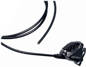
1. Die Bremsleitung muss am Bremssattel befestigt sein.
