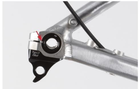
Abb. zeigt: Insert mit Klemmschlitz korrekt ausgerichtet
