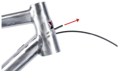
6. Bremsleitung beim Steuerrohr links oben herausführen
