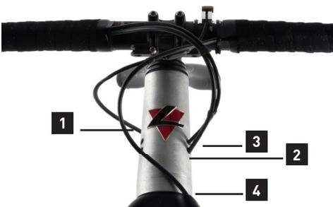
Abb. zeigt: Beispielhaft 1 x 11 Antriebseinheit, Bremseinheit und Vario-Stütze von vorne
