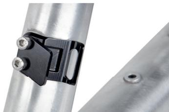
Abb. FD-Mount Setback und Support Plate montiert
