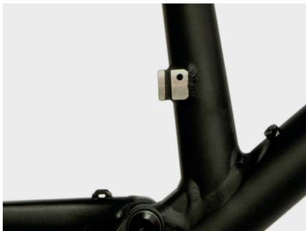
Abb.: Freiraum zwischen Kettenführung und Kettenstreben
